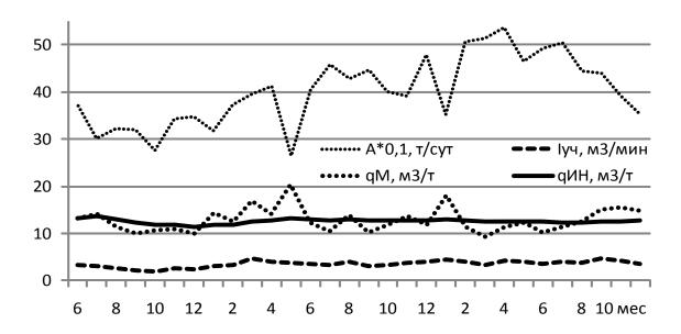
Рис. 2 — Динамика **по**месячного изменения интегральной  $q_{un}$  и месячной  $q_{M}$  метанообильности, среднесуточной добычи A и абсолютной метанообильности I по участку 1 и 2 западных лав пласта  $l_8^B$  гор. 710м шахты им. Ильича
