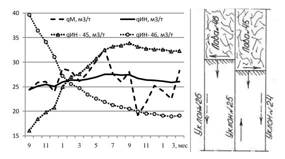
Рис.1 — Динамика помесячного изменения интегральной  $q_{uh}$  и месячной  $q_{M}$  метанообильности по участку спаренных 45  $(q_{uh}$  - 45) и 46  $(q_{uh}$  - 46) лав пласта  $k_3^{\ \ l}$  шахты им. Кирова, отрабатываемых по приведенной схеме.
