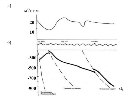
Рис. 8 – Изменение газоносности угольного пласта d<sub>4</sub> (a) и схематический разрез вкрест простирания горных пород (б) на поле шахты «Красноармейская-Западная № 1»
